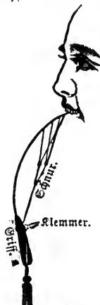
Fig. 3. Das Audiphone den oberen Zähnen angepaßt; zum Gebrauch bereit. (Seiten-Ansicht.)
